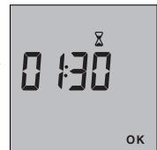
Stellen Sie die gewünschte Zeitspanne (von 30 Minuten bis 72 Stunden) an der Taste + oder – ein (z.B. 1h30) und bestätigen Sie mit OK.
